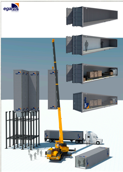
Imatge descriptiva del projecte. El contenidor ple dels elements que conformen una sitja en posició horitzontal i, com, arribant al lloc, es gira i ja es col·loca directament sobre l'estructura
